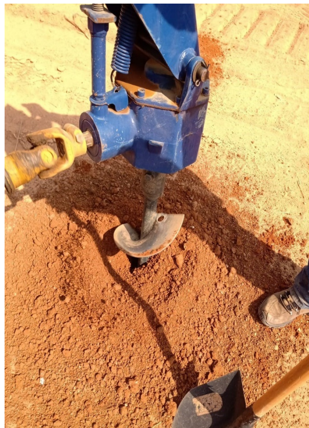
– Sondagem e Coleta de Amostra
