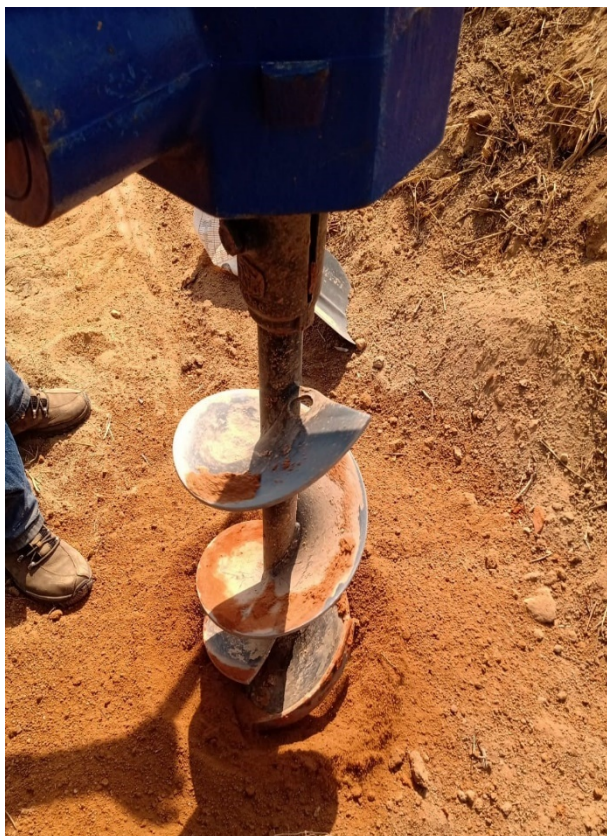
– Sondagem e Coleta de Amostra
