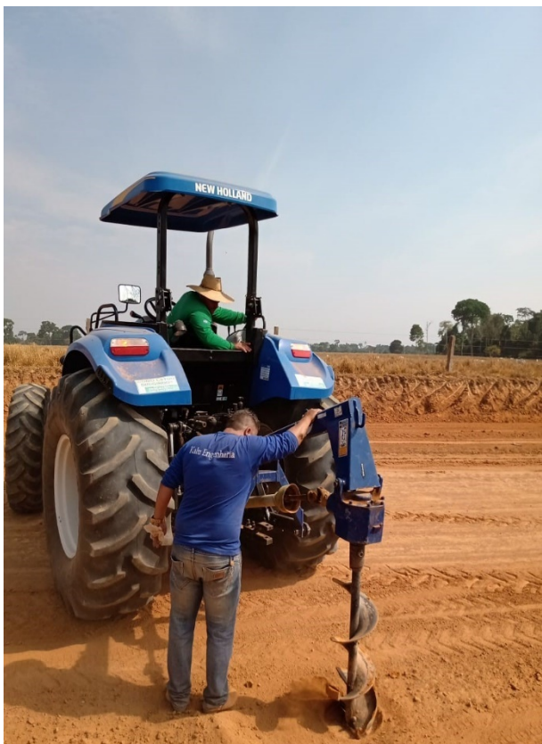
– Sondagem e Coleta de Amostra
