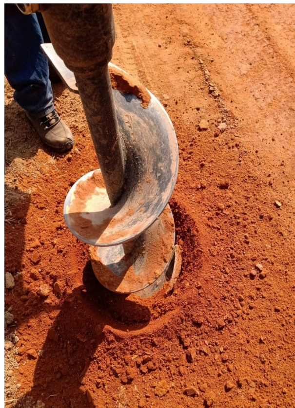
– Sondagem e Coleta de Amostra
