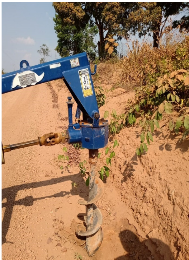
– Sondagem e Coleta de Amostra
