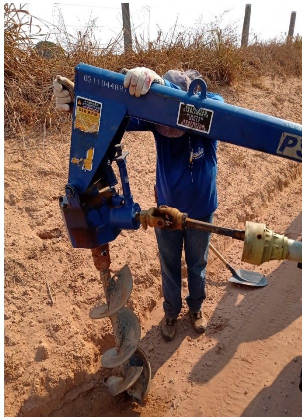
– Sondagem e Coleta de Amostra
