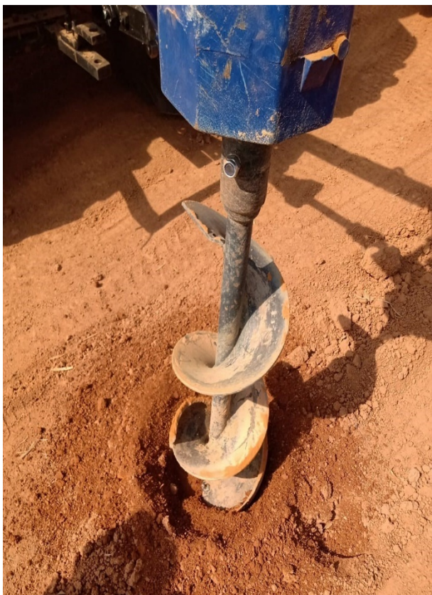
– Sondagem e Coleta de Amostra
